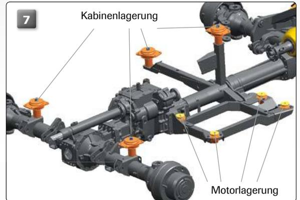
**Zentralrohr mit Motoraufhängung und Kabinenlagerung.**
