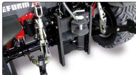
Besonders vorteilhaft sind die höhenverstellbaren **Anhängekupplungen mit Schlitten** (mechanisch, automatisch oder mit Kugelkopf).
