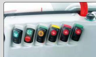
Bei der leistungsstarken Arbeitshydraulik sind die **Hydraulikkupplungen** leicht zugänglich und farblich gekennzeichnet. Gemeinsam mit der **elektrischen Außenbetätigung** der Hubwerke wird damit das Ankuppeln von Arbeitsgeräten besonders einfach.
