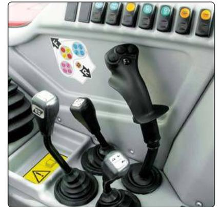
Die Schalthebel sind ergonomisch und übersichtlich angeordnet.
