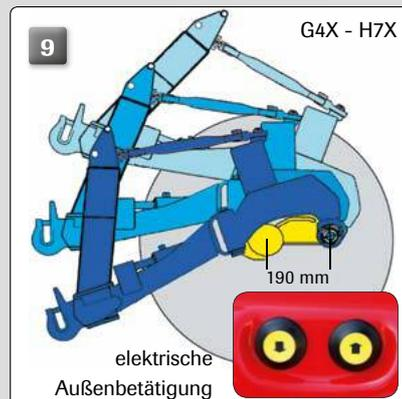
Das starke, achsgeführte **Fronthubwerk (9)** gewährleistet beste Boden-anpassung durch weit hinter der Vorderachse liegende Drehpunkte. Die serienmäßige hydraulische (G3) oder elektro-hydraulische Geräteentlastung sorgt für höhere Traktion sowie bessere Steigfähigkeit bei gleichzeitig bester Boden-anpassung und -schonung. Seitenverschub: Noch größere Hangtauglichkeit durch Schwerpunktverlagerung. Ermöglicht das nahe Arbeiten an Hindernissen und erleichtert den Geräteanbau.
