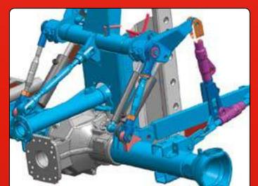
Besondere Stabilität wird durch die Abstützung des Heckhubwerkes, mittels Zugstreben auf die Hinterachse, erreicht.
