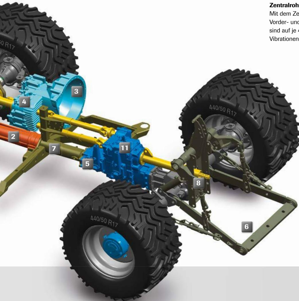
**8** Die **Heckzapfwelle** ist elektrohydraulisch schaltbar und gewährleistet dank der automatischen Anlaufsteuerung ein sanftes Anlaufen von Arbeitsgeräten (gilt nicht für G3: Getriebezapfwelle hinten).
