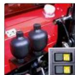
**Gasdruckspeicher** absorbieren einen großen Teil der Schwingungen, die beim Fahren mit schweren Anbaugeräten, besonders bei Straßenfahrten, auftreten.
