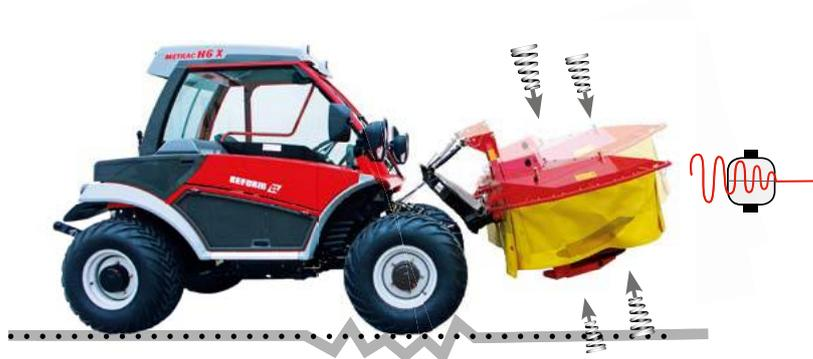
Die Stoßbelastungen werden durch Gasdruckspeicher minimiert.
