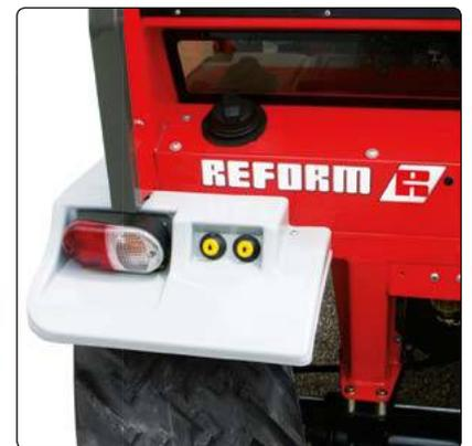
Der leicht zugängliche **Einfüllstutzen** ermöglicht einen schnellen Tankstopp und die **elektrische Außenbetätigung** für das Hubwerk erleichtert den An- und Abbau Ihrer Arbeitsgeräte.
