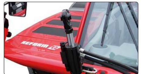
Mit dem **hydraulischen Oberlenker** können Sie rasch von der Kabine aus auf Bodenunebenheiten reagieren oder bequem auf Knopfdruck die Schnitthöhe verstellen.
