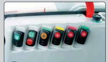
Bei der leistungsstarken Arbeitshydraulik sind die **Hydraulikkupplungen** leicht zugänglich und farblich gekennzeichnet. Gemeinsam mit der **elektrischen Außenbetätigung** der Hubwerke wird damit das Ankuppeln von Arbeitsgeräten besonders einfach.
