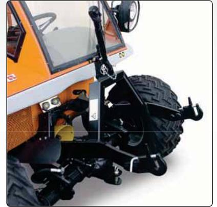
Die Metrac Modelle G4 X und H4 X haben serienmäßig ein **starres Fronthubwerk**, auf Wunsch können sie auch mit einem hydraulischen Seitenverschub ausgestattet werden.
