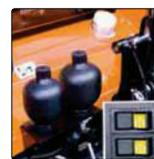
**Gasdruckspeicher** absorbieren einen großen Teil der Schwingungen, die beim Fahren mit schweren Anbaugeräten, besonders bei Straßenfahrten, auftreten.
