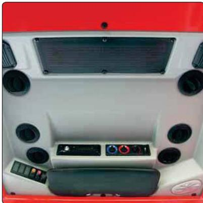
**Verstellbare Ausströmdüsen** im Dachbereich, Luftauslässe zur Windschutzscheibe sowie im Fußraum ermöglichen es dem Fahrer, sein individuelles Arbeitsklima zu schaffen.
