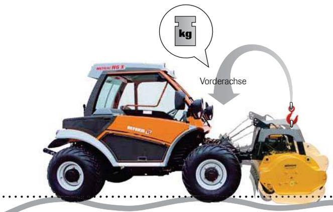
Das Arbeitsgerät folgt den Bodenkonturen ohne Veränderung des Entlastungsdruckes.
