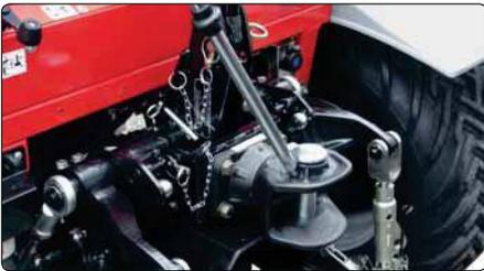
Für verschiedene Einsatzzwecke stehen mechanische oder automatische **Anhängekupplungen** zur Verfügung.
