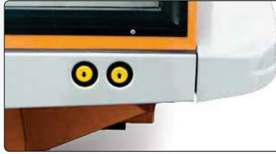
Die **elektrische Außenbetätigung** für das Fronthubwerk ist Standard und erleichtert das Ankuppeln von Arbeitsgeräten.
