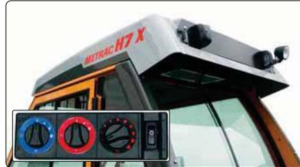
Angenehmes Arbeitsklima mit der in das Dach integrierten **Klimaanlage** oder zusätzliche Frischluftzufuhr, bei geschlossener Kabine, über die ebenfalls integrierte **Dachbelüftungsanlage**.
