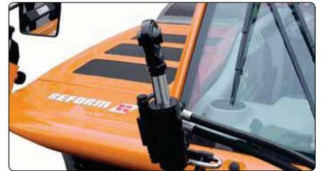
Mit dem **hydraulischen Oberlenker** können Sie rasch von der Kabine aus auf Bodenunebenheiten reagieren oder bequem auf Knopfdruck die Arbeitstiefe verstellen.
