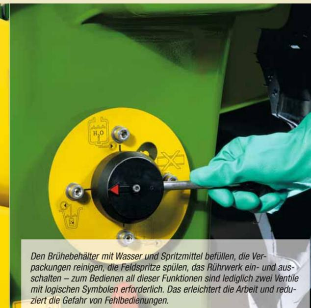
Den Brühbehälter mit Wasser und Spritzmittel befüllen, die Verpackungen reinigen, die Feldspritze spülen, das Rührwerk ein- und ausschalten – zum Bedienen all dieser Funktionen sind lediglich zwei Ventile mit logischen Symbolen erforderlich. Das erleichtert die Arbeit und reduziert die Gefahr von Fehlbedienungen.
