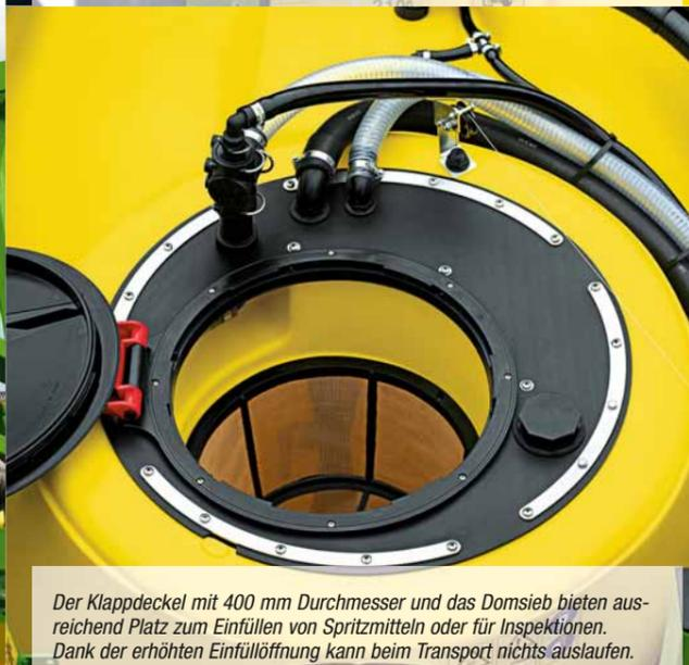
Der Klappdeckel mit 400 mm Durchmesser und das Domsieb bieten ausreichend Platz zum Einfüllen von Spritzmitteln oder für Inspektionen. Dank der erhöhten Einfüllöffnung kann beim Transport nichts auslaufen.
