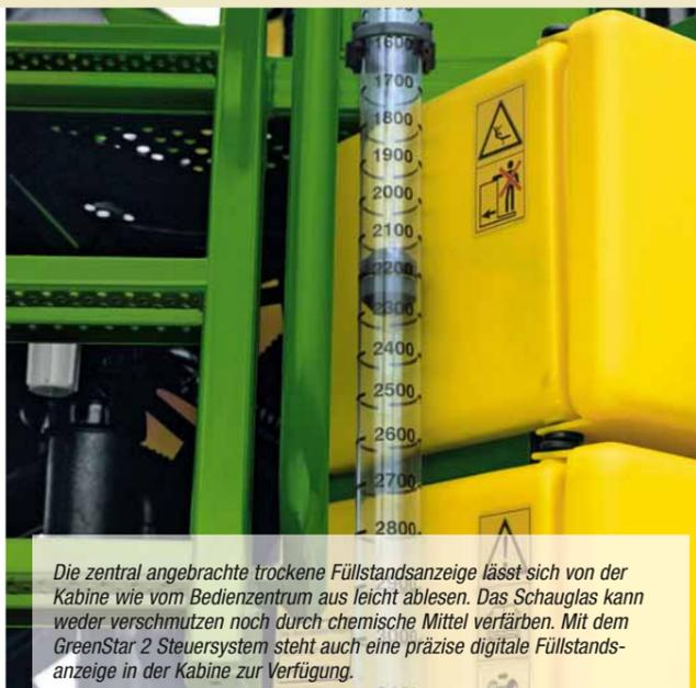
Die zentral angebrachte trockene Füllstandsanzeige lässt sich von der Kabine wie vom Bedienzentrum aus leicht ablesen. Das Schauglas kann weder verschmutzen noch durch chemische Mittel verfärben. Mit dem GreenStar 2 Steuersystem steht auch eine präzise digitale Füllstandsanzeige in der Kabine zur Verfügung.
