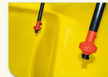
Einfach bequem, präzise und sicher: Über zwei rotierende Düsen im Brühebehälter lässt sich die Feldspritze gründlich reinigen.
