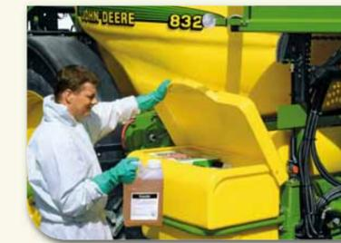
Die große Box rechts an der Feldspritze bietet Platz für den Transport der Spritzmittel. Der Deckel lässt sich auf zwei Arten öffnen; so haben Sie rasch Zugang zu kleineren wie zu größeren Gebinden. Über das Ablaufventil lässt sich die Box gründlich reinigen.
