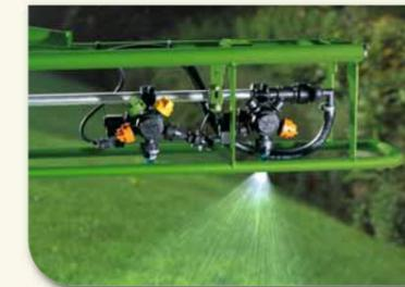
*Äußerst komfortabel sind Fünffachdüsenkörper. Sie erlauben den raschen Wechsel zwischen maximal fünf verschiedenen Düsentypen sowie das schnelle Abschalten einzelner Düsen über eine Blindposition.*
