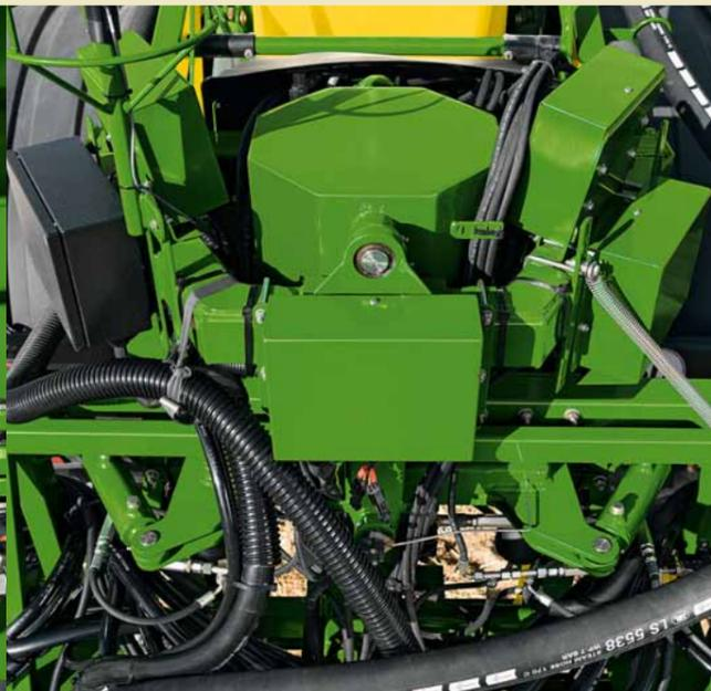
Das Gestänge ist mit einem hydraulischen Hangausgleichszylinder ausgerüstet. Beim Einsatz am Hang lässt sich damit das Gestänge parallel zum Feld einstellen, und die Pendelwirkung bleibt voll erhalten. Die manuelle Steuerung erfolgt über ein Drehpotentiometer oder über den Multifunktionshebel. Damit kann das Gestänge rasch und präzise in jede gewünschte Position gebracht werden.
