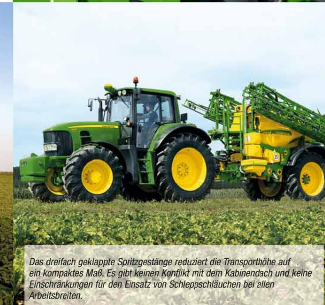
Das dreifach geklappte Spritzgestänge reduziert die Transporthöhe auf ein kompaktes Maß. Es gibt keinen Konflikt mit dem Kabinendach und keine Einschränkungen für den Einsatz von Schleppschläuchen bei allen Arbeitsbreiten.
