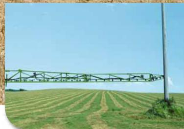
*Alle John Deere Feldspritzleitungen sind serienmäßig mit einem Anfahrerschutz ausgerüstet. Dadurch können die Außenteile der Spritzleitungen bei Kontakt mit einem Hindernis nach hinten oder nach vorne und nach oben wegklappen. Das verhindert Schäden an der Spritzleitung.*
