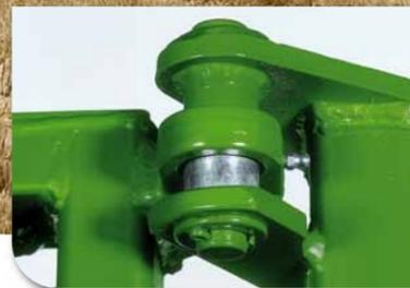
*Alle Drehpunkte des Gestänges bestehen aus selbst einstellenden schmierbaren Kugelgelenklagern, die auch nach Jahren dafür sorgen, dass das Gestänge nicht durchhängt.*
