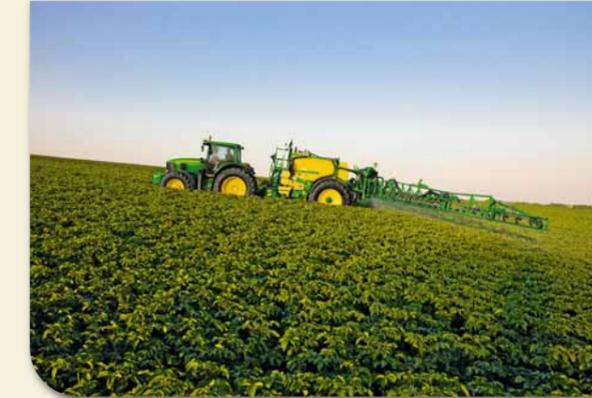
**BoomTrac** – die automatische Gestängeführung der Feldspritze erhöht die Verteilgenauigkeit, erlaubt höhere Fahrgeschwindigkeiten und entlastet den Fahrer
