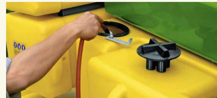
Der Spülwasserbehälter mit 400 l Inhalt liegt unter dem Brühebehälter vorne im Rahmen. Das erleichtert das Befüllen, senkt den Schwerpunkt und verbessert die Gewichtsübertragung auf den Traktor. Mit dem Spülwasserbehälter lässt sich die Feldspritze mit klarem Wasser spülen – bei vollem wie bei leerem Brühebehälter.
