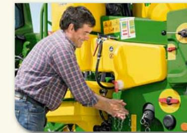
Zum Händewaschen sowie zum Reinigen von Kleinteilen steht ein separater Handwaschbehälter mit 20 Liter Inhalt sowie ein Seifenspender zur Verfügung. Dieser Behälter lässt sich zum Befüllen einfach abnehmen.
