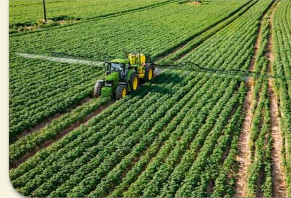
**Sprayer Pro** – automatische Teilbreitenschaltung der Feldspritze und Schließen des Hauptabsperrentils am Vorgewende. Spart Pflanzenschutzmittel und schont den Bestand.
