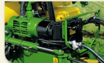
Beim TwinFluid-System wird Luft von ölfreien, luftgekühlten Kompressoren geliefert, die über die Zapfwelle des Traktors angetrieben werden.
