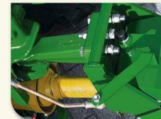
Die automatische Nachlaufeinrichtung sorgt über zwei Sensoren und die längenverstellbare Deichsel für einen spurgetreuen Nachlauf. Die Deichsellenkung ist mit einem (Serie) oder mit zwei hydraulischen Lenkzylindern (Wahlrüstung) lieferbar, die einen Einsatz selbst an steilsten Hängen ermöglichen.
