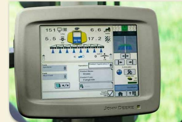
**ISOBUS** – Steuerung ISO-konformer Anbaugeräte und Maschinen mit nur einem Monitor. Perfekte Kommunikation und Zusammenarbeit auch mit Anbaugeräten anderer Hersteller.
