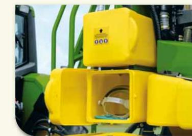
Zwei verschließbare Fächer bieten ausreichend Platz für Schutzkleidung oder Düsen, Filter und Reinigungsbürsten – eines für kontaminierte Schutzkleidung, das andere für saubere Teile.
