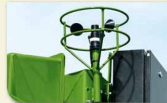
Mit einem Windmesser lassen sich die tatsächlichen Windgeschwindigkeiten feststellen. Der TwinFluid-Controller empfiehlt dem Fahrer auf der Basis dieser Messung die geeignete Tropfengröße und warnt bei zu hohen Windgeschwindigkeiten.
