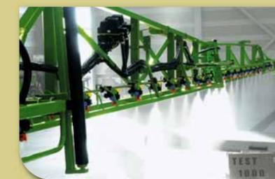
Alle John Deere Feldspritzen kommen vor ihrer Auslieferung im Werk auf den Prüfstand. Dort wird das Spritzbild geprüft, indem Durchflussmenge und Querverteilung gemessen werden, um die höchste Genauigkeit bei der Ausbringung zu gewährleisten.
