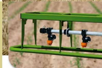
*Das Spritzgestänge ist mit Spritzleitungen aus VA-Stahl ausgerüstet. Das bedeutet viele Jahre zuverlässigen, störungsfreien Betrieb.*
