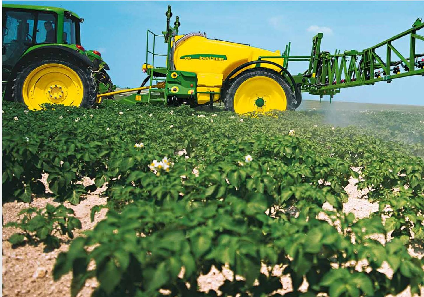
**Das Klappen des Spritzgestänges erfolgt schnell, einfach und schonend** über Hydraulikzylinder mit Endlagendämpfung. Hier werden Langlebigkeit und Wartungsfreundlichkeit groß geschrieben: Es gibt weder Kettenräder noch Ketten oder Drahtseile.
