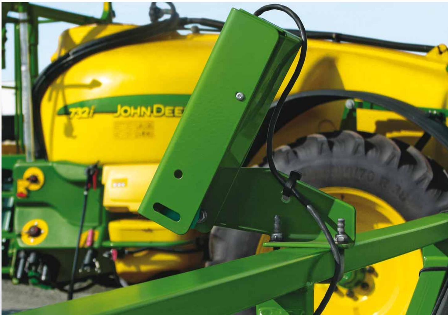
**BoomTrac:** Befindet sich das Gestänge nicht parallel zur Zielfläche, korrigiert BoomTrac Höhe und Neigung, bis das Gestänge wieder parallel zum Bestand ausgerichtet ist – in genau der richtigen Höhe.
