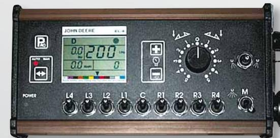
**Spritzcomputer EL-4 mit automatischer Ausbringmengenregelung:** einfache, zuverlässige Steuerung aller Funktionen des Flüssigkeitssystems.
