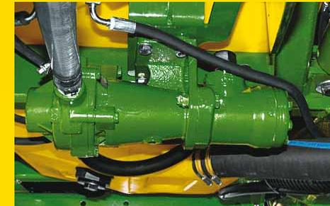
**AutoDilute:** Über eine separate Pumpe wird Wasser aus dem Klarwassertank in die Spüldüsen gepumpt, um die Restflüssigkeit zu verdünnen. Die Spritzpumpe lässt die verdünnte Flüssigkeit durch die komplette Feldspritze und das Spritzgestänge zirkulieren. Der gesamte Verdünnungsprozess lässt sich über ein Menü im GreenStar Monitor steuern.
