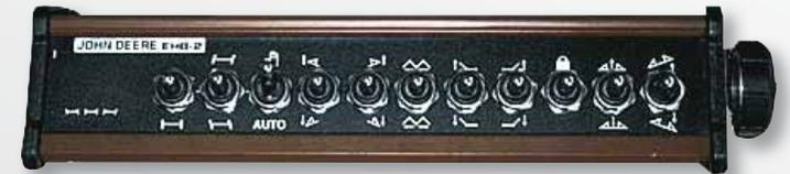
Mit den elektrohydraulischen Bedienungen (EHS-1, EHB-1, EHB-2) lassen sich alle Funktionen des Spritzgestänges und der Universaldeichsel bequem steuern.
