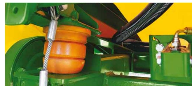
Die **gedeferte Zweilenkerachse** als Wahlausrüstung sorgt für Laufruhe, präzisere Spritzergebnisse und schnellen Straßentransport
