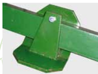
Gleitkufen für besonders feuchte Böden
