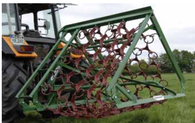
5 m Egge, 4-reihig, mechanisch klappbar
