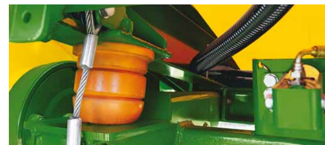
Die gefederte Zweilenkerachse als Wahlausrüstung sorgt für Laufruhe, präzisere Spritzergebnisse und schnellen Straßentransport
