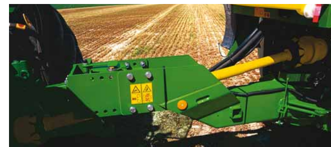
Bei der schmalen Universaldeichsel gibt es keinen Konflikt mit den Traktorrädern
