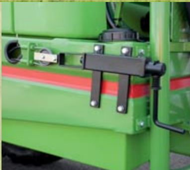
Sonderausstattung Handbremse für sicheres Abstellen: nur in Kombination mit Druckluftbremsanlage
