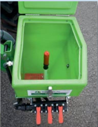
Serienausstattung Schleuse mit Ringreinigungs- leitung und Kanisterrotations- Reinigungsdüse Saugleistung ca. 60l/min
