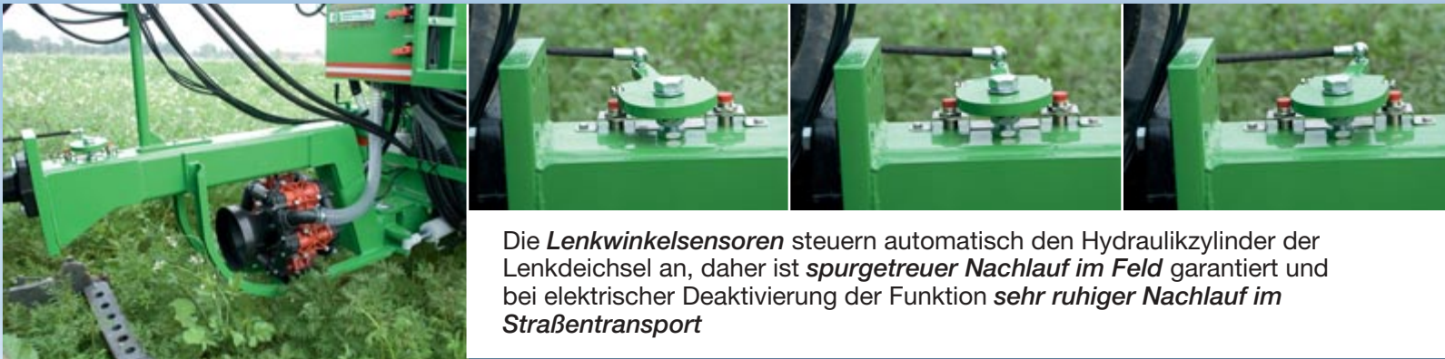
Sonderausstattung: NEU entwickelte Zugmaul-Lenkdeichsel mit Lenkwinkelsensoren
