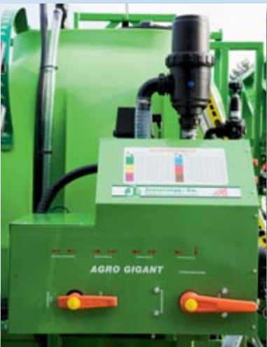
Serienausstattung Selbserklärendes Duo-Command-System: nur zwei Hebel steuern die Grundfunktionen
