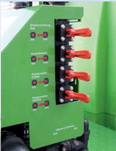
Serienausstattung Einfachste Ansteuerung: Einspülsieb, zwei extra schaltbare Rührwerksdüsen und Druckrührwerk
