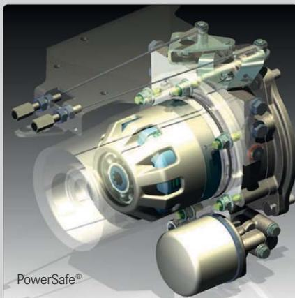
Die hydraulische Ölbadkupplung **PowerSafe®** ermöglicht sicheres Manövrieren des Einachsers. Sie schützt den Bediener, sobald der Totmanngriff losgelassen wird; Der Motor läuft weiter, Arbeitswerkzeug und Fahrtrieb werden gestoppt und eingebremst.
