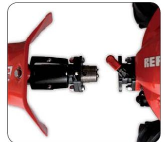
Das für alle Modelle optional erhältliche **REFORM Schnellverschlussystem** ermöglicht einen komfortablen und raschen Gerätewechsel.
