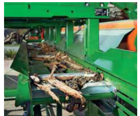
Zusatzrüstung: Das optionale Reinigungsband fördert Holzabfälle unter dem Querförderer in einen beliebigen Container.
