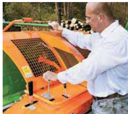
Die Bedienung des Holzniederhalters und des Sägeblattes erfolgt mit dem ergonomischen Handvorschub.
