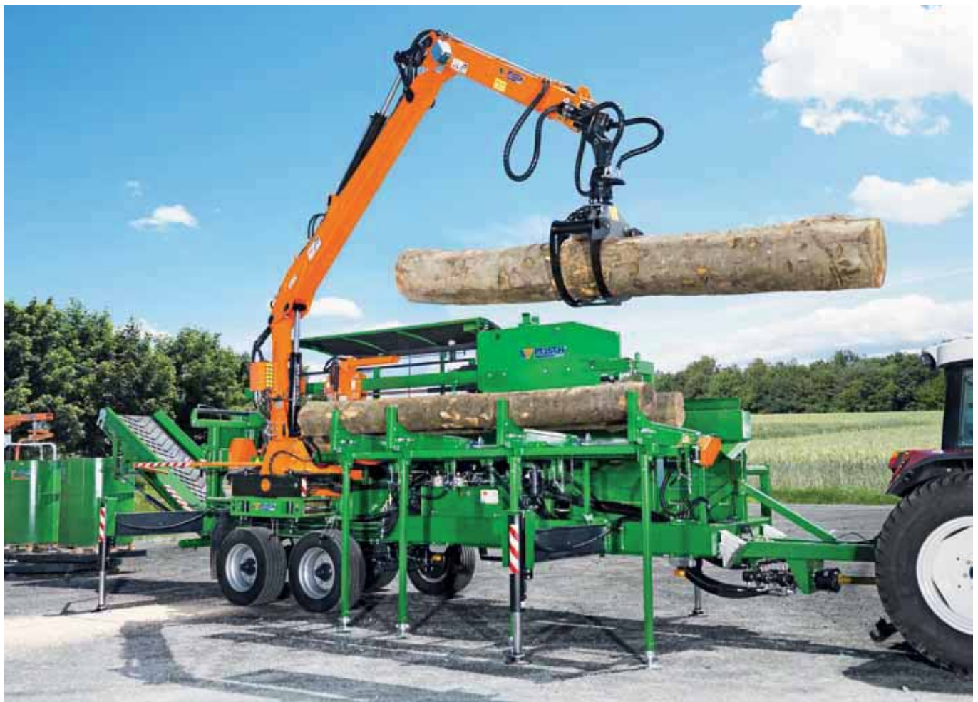
Mobiler SpaltFix K-550 Spezial mit Holzladekran und Knickförderband für den Holzabtransport.
