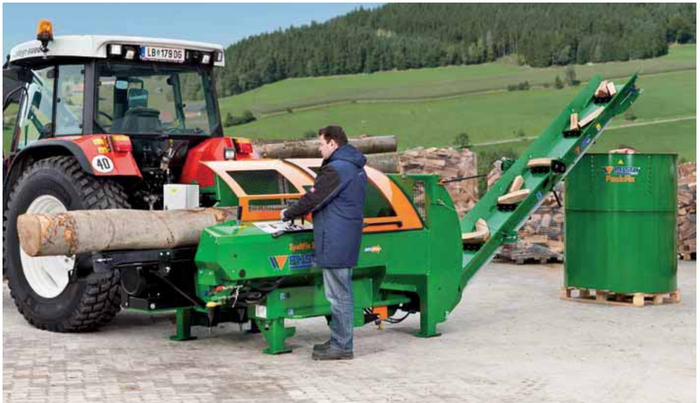
SpaltFix S-360 ZE22D mit Knickförderband für den Holzabtransport und Verpackungslösung PackFix zur optimalen Verpackung von Brennholz.
