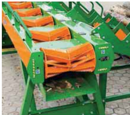
Robuster Walzenförderer zur kontinuierlichen Beschickung des Spaltfix.
