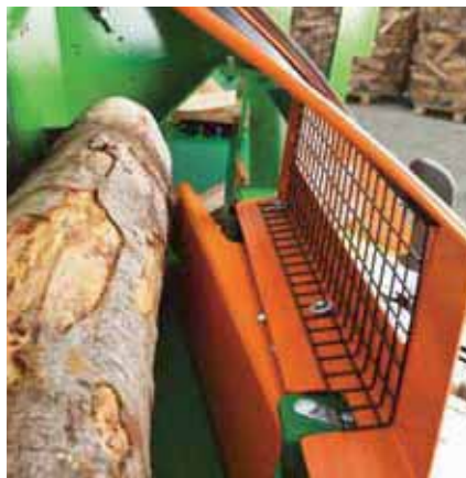
Der hydraulische Holzniederhalter verhindert ein Klemmen des Holzstückes.
