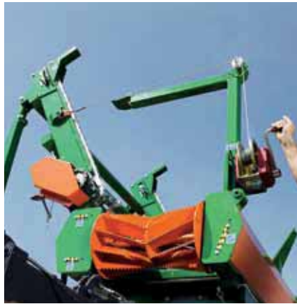
Der Querförderer kann bequem mittels Seilzug oder hydraulisch in Arbeitsstellung gebracht werden.
