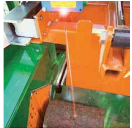
SplitControl für die automatische Holz mengenmessung und Spaltmesserverstellung. Gleichmäßigere Holz-scheite sind das Ergebnis.
