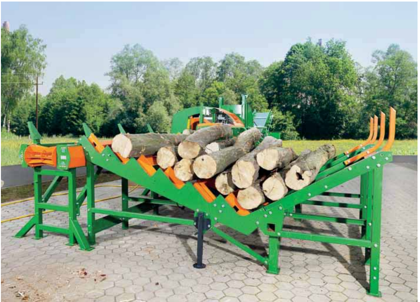
Mit dem Stufenförderer können größere Holz-mengen abgeladen werden. Während der Übergabe an den Walzenförderer werden die Holzstämme automatisch vereinzelt.
