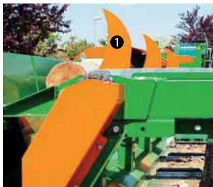
Der optionale Vereinzeln-Stern 1 übergibt die Holzstämmen einzeln dem Längsförderer.
