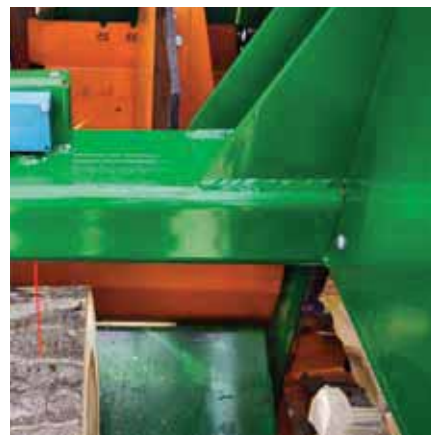
SplitControl für die automatische Holz mengenmessung und Spaltmesserverstellung. Gleichmäßigere Holz-scheite sind das Ergebnis.
