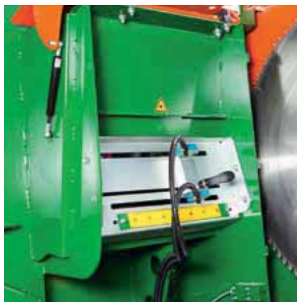
Die Holzlängenmessung ist über den optischen Sensor stufenlos einstellbar.
