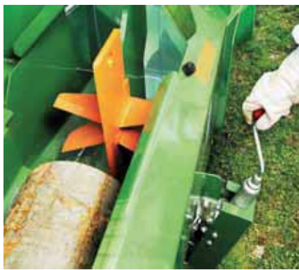
Das Spaltmesser ist in der Höhe von Hand leicht verstellbar.
