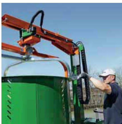
Die Befüll-Trommel kann einfach mit einem Handgriff von der Rahmenkonstruktion abgekoppelt werden.
