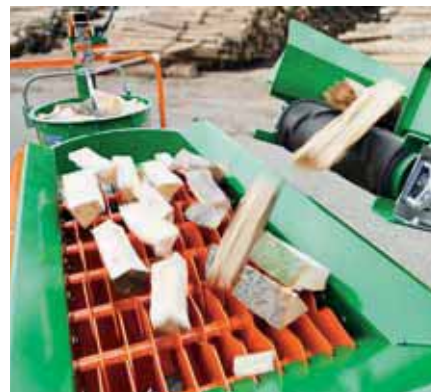
Die rotierenden Walzen lösen die unerwünschten Späne und Rindenstückchen vom Brennholz.
