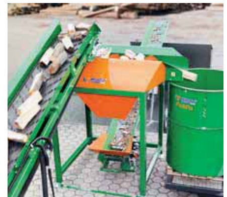
Ein optionales Förderband unter dem Sieb übergibt die Abfallstücke an einen beliebigen Container. Die sauberen Holzscheite fallen hier in eine PackFix-Befülltrommel.
