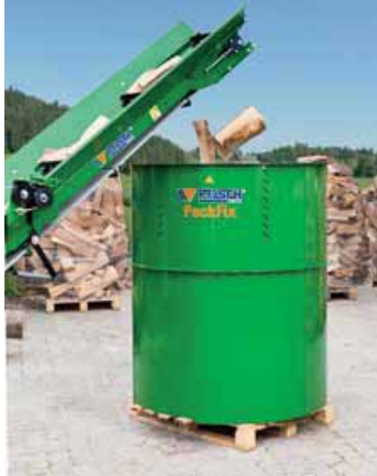
Die PackFix Trommel wird über ein Förderband befüllt.
