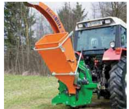
HackBlitz 500 mit Antrieb über Zapfwelle in Transport-stellung.
