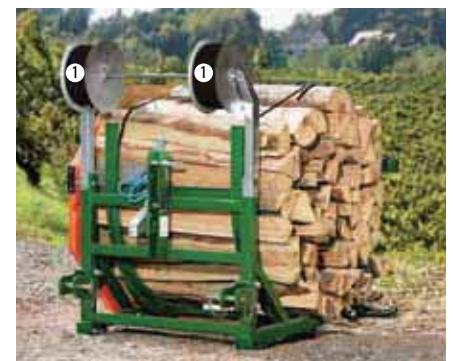
Bündelsystem mit Kompositband. ❶ Abroller für Kompositband (M7200 + F0002557 + F0002797)
