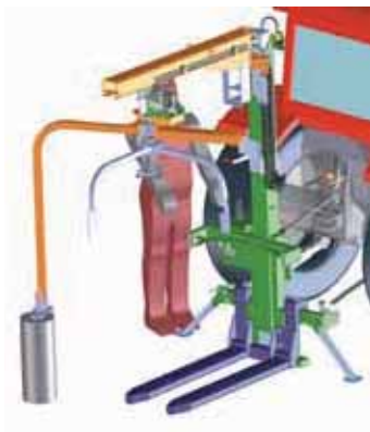
PackFix Hydro Mobil (M7340) mit Dreipunktaufhängung und Palettengabel
