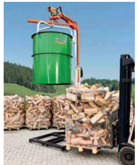
Nachdem die Befüll-Trommel vollständig nach oben weggezogen wurde, kann der fertige „Holzpack“ abtransportiert werden.
