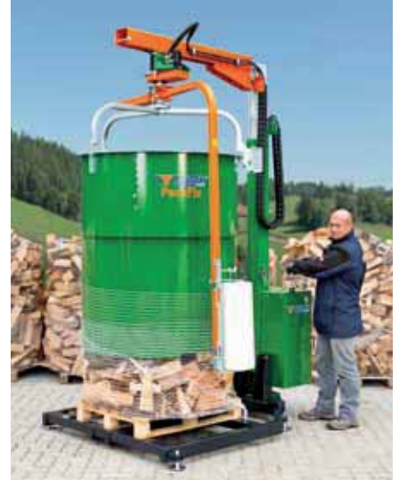
Der Rotationsarm umwickelt die Befülltrommel mit dem Rundballnetz ...
