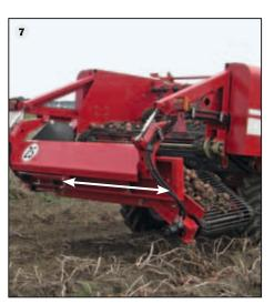
Ein Schwingklopfer (6) sorgt für zusätzliche schonende Absiebung auf dem ersten Siebband. Optional kann die Intensität der Klopfer stufenlos elektrisch verstellt werden.
