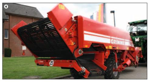
Der Feinkrautelevator (4) am WR 200 steigert die Trennleistung der Maschine zusätzlich.
