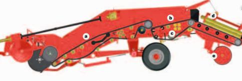
3 WR 200 mit 1. Siebband (a) und 2. verlängertem Siebband (b) mit Rotorklopfer (c). Für die schonende, mittige Ablage
