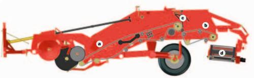
4 WR 200 mit 1. (a) und 2. (b) Siebband, einer Zupfeinheit (c) und Querablageband (d) für die schonende Ablage der Kartoffeln zwischen den nächsten Reihen.
