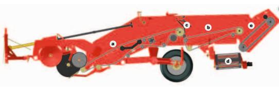
5 WR 200 mit 1. (a) und 2. (b) Siebband, einer Zupfeinheit (c) und Querablageband (d) für die schonende Ablage der Kartoffeln zwischen den nächsten Reihen. Für noch mehr Trennleistung verfügt die Maschine über einen zusätzlichen Feinkrautelevator (e)
