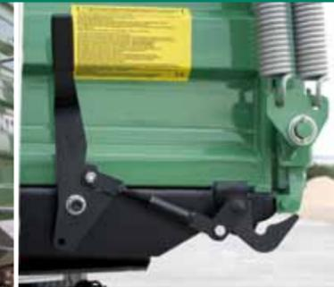
**Pendelwand mit Zentralverriegelungshebel**
