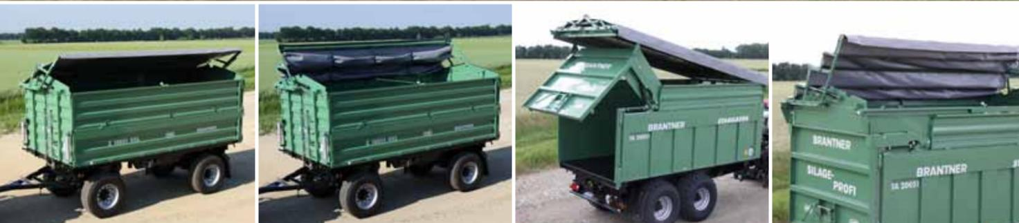
**Planenaufbau und NEUER hydraulischer Planenaufbau "Cabriplane" auch in Kombination mit hydr. Rückwand möglich**
