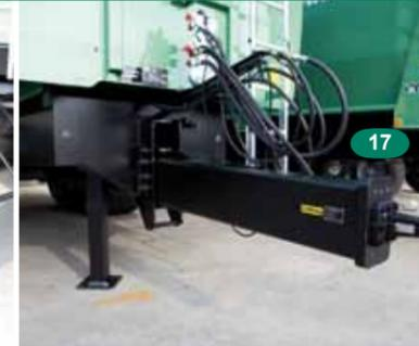
**Untenanhängung mit Zugrohr**
