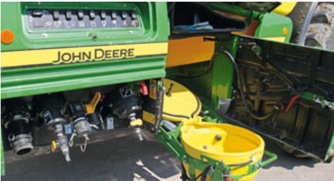
*Die Ventile werden elektrisch bedient, die Einspülschleuse funktionierte sehr gut. Auch die Befüllleistung ist prima. Verbessern könnte John Deere die Schalter und die Symbolik.*
