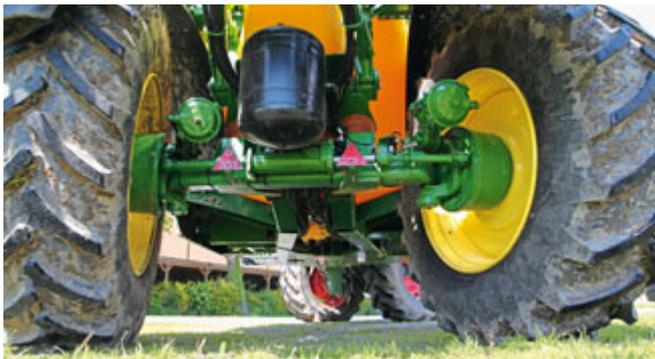
*Die Achse ist mit vier Polyurethan-Blöcken gefedert und bietet stolze 83 cm durchgehende Bodenfreiheit. Fotos: Wilmer*
