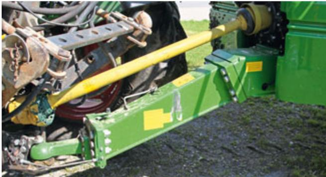
*Neben der Kugelhauptkupplung sitzt das einfache Gestänge zur Ansteuerung der Achsschenkel lenkung – das funktioniert super! Die Unterlenker müssen allerdings gewaltig hoch ausgehoben werden, um die Gelenkwelle nicht zu beschädigen.*
