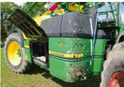
Das Staufach kostet stolze 840 Euro, ist aber schön groß und absolut dicht. Der Klarwasserbehälter hat sogar eine digitale Füllstandsanzeige und kann vom Bedienzentrum aus mit 2-Zoll-Anschluss schnell gefüllt werden.
