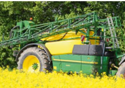
Das 24-m-Gestänge wird nur zweifach geklappt. Damit ist die Spritze 7,50 m lang, 2,93 m breit und 3,62 m hoch. Das Fahrverhalten war aber sehr gut.
