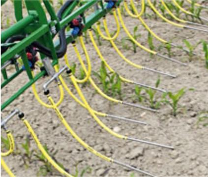
Die Fünffach-Düsenträger sind serienmäßig und die Schleppschläuche lassen sich einfach koppeln. Automatische Mehrfachdüsenträger gibt es nicht, aber eine automatische Teilbreitenschaltung und eine kontinuierliche Zirkulation.
