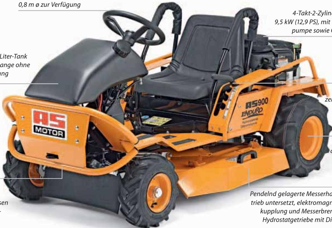
4-Takt-2-Zylinder OHV-Motor, 9,5 kW (12,9 PS), mit Öl- und Benzinpumpe sowie Öldruckschalter
