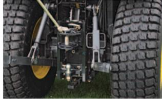
**Höhenverstellb. Anhängerkupplung:** Kugelkopfanhängung mit Zughaken und praktischer Höhenverstellung zum leichten Anhängen verschiedener Anhänger.
