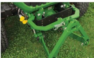
**Frontkraftheber mit Zapfwelle:** Kuppeldreieck für den schnellen Anbaugerätewechsel.
