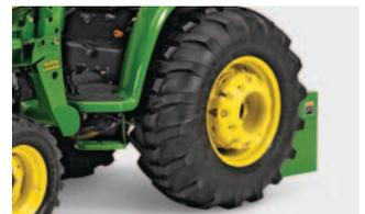
**Heckradgewichte:** Damit verbessern Sie die Traktion und Stabilität bei Einsätzen auf rutschigem Boden sowie bei Frontlader- und Schneeräumarbeiten.
