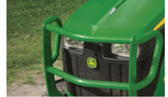
**Rammschutz:** Dieses Zubehör schützt Ihren Kühlergrill bei Fahrten durch dichtes Gebüsch und vor möglichen Stößen bei Frontladereinsätzen.
