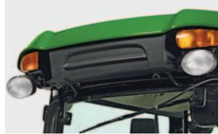
**Arbeitsscheinwerfer hinten:** Mit diesem Set sorgen Sie für eine optimale Ausleuchtung insbesondere bei der Arbeit mit Heckanbaugeräten.
