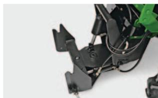
**„Quick Hitch“ Frontkraftheber mit Zapfwelle:** Für den An- und Abbau Ihrer Arbeitsgeräte in Sekundenschnelle.
