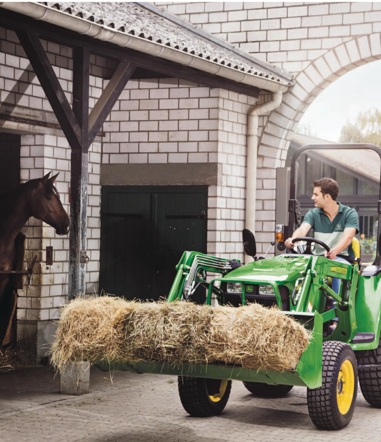
Unsere Serie 3E besticht im Vergleich zu anderen Standardtraktoren durch klassenbeste Leistung und exklusive Ausstattungen: Leistungsstarker 3-Zylinder Dieselmotor, Hydrostat-Getriebe, Allradantrieb, 3 Punkt-Heckkraftheber der Kategorie 1 und unabhängige Zapfwelle machen den 3E zu einem echten Allrounder auf Ihrem Hof.
