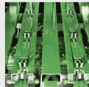
Der zuletzt gepresste Ballen wird mittels hydraulischer Gabel sauber ausgeworfen.
