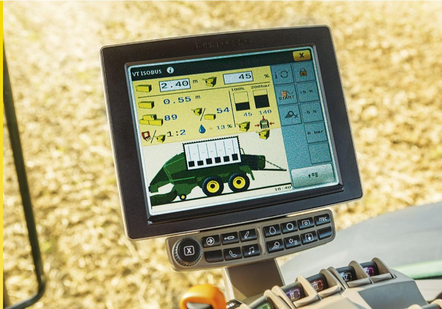
Die Großpackenpressen der Serie L1500 können bequem über die GreenStar 2 1800 oder GreenStar 3 2630 Displays oder aber über die CommandCenter Displays ihrer Traktoren gesteuert werden.
