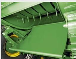
Eine weit öffnende Bodenklappe vereinfacht die Entleerung einer überladenen Vorkammer und bietet einfachen Zugang für Wartungszwecke.
