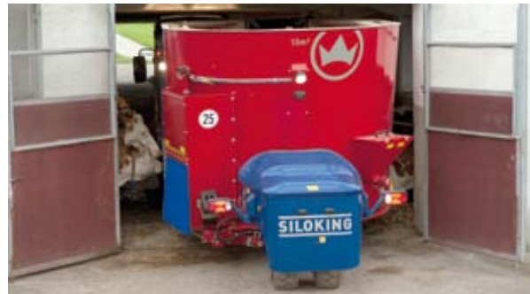
Kompakte Bauweise und beidseitiger Austrag ohne Überfahren des Futters.
