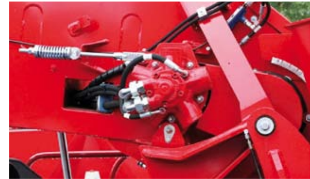
Oben am Fräskanal angeordneter Antrieb.
