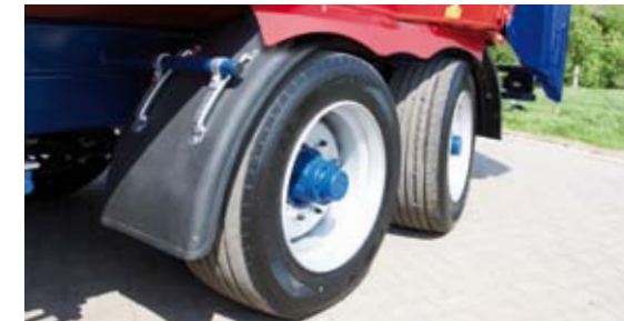
Zwangslenkung für hervorragende Wendigkeit (optional).
