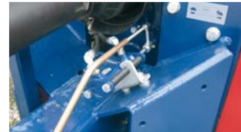
Hydraulische Umschaltung des Schaltgetriebes.
