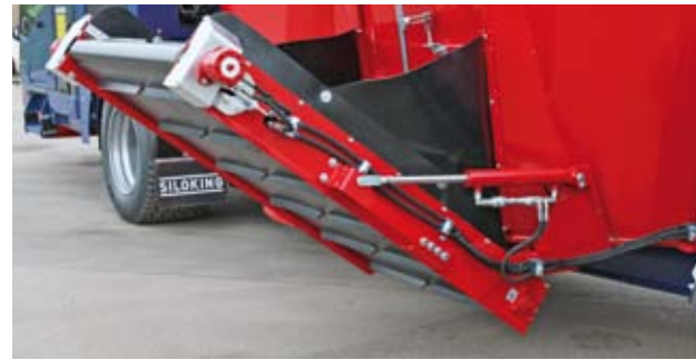
Der klappbare Austragsförderer dient zur Futterablage auch in höhere Tröge.
