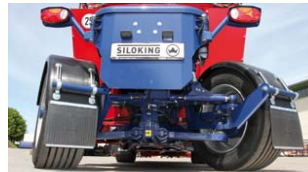
Bei schwierigen Wegverhältnissen kann der SelfLine Premium optional mit einer Einzelradaufhängung ausgestattet werden – Standard bei SelfLine Premium 2215-22.
