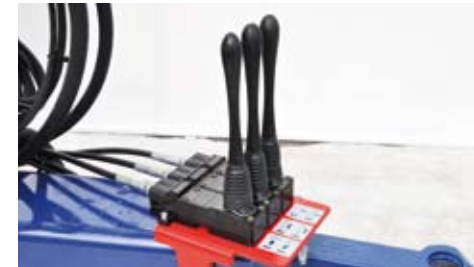
Steuergerät mit Bowdenzugbedienung.
