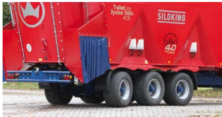
Standardmäßig mit Tridemaggregat mit 2 Lenkachsen.
