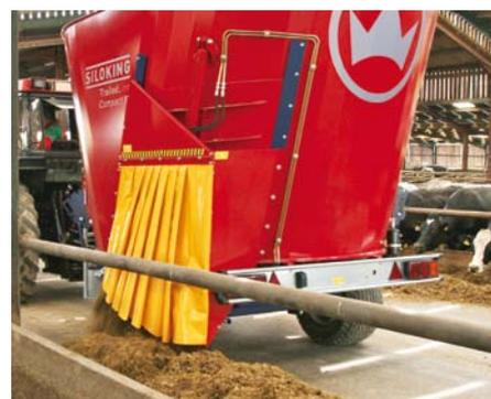
Exakte Dosierung auch bei Austragsschieber hinten links.
