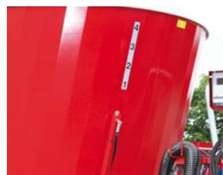
Hydraulische Schieberanzeige ist absolut genau und ist korrosionsschutz für lange Lebensdauer.
