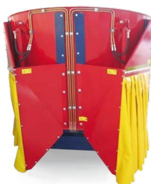
Zwei Austragsschieber hinten zur Mitte versetzt ermöglichen in schmalen Futtergängen einen gleichzeitigen Austrag auf beiden Seiten.
