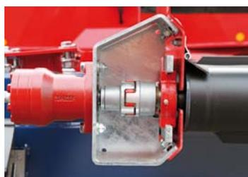
Die Kupplung zwischen Hydraulikölmotor und Antriebswalze sorgt für einen sauberen Lauf und eine Reduzierung der Kräfte auf die Antriebswelle.
