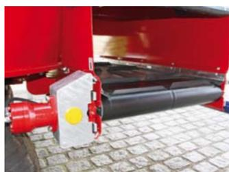
Das SILOKING Querförderband arbeitet mit unterschiedlichen Steghöhen für höhere Leistung und mehr Betriebssicherheit.
