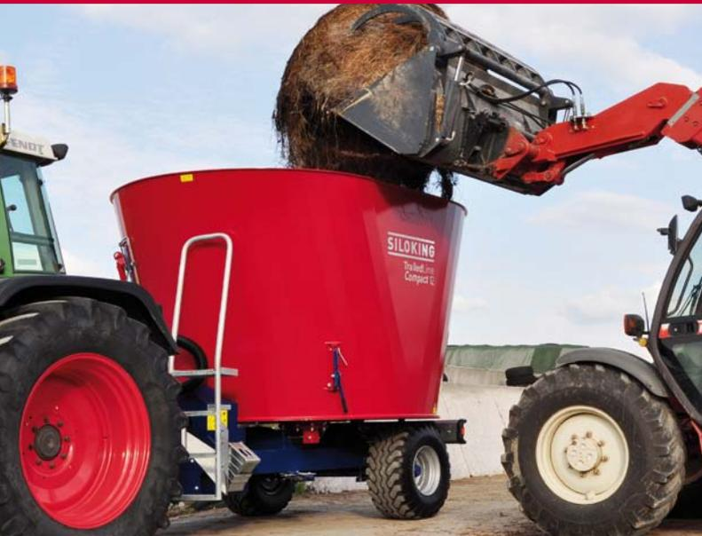
Durch ihre Behältergeometrie und den robusten Antrieb eignet sich die Maschine neben den Standardmischungen auch hervorragend zum Auflösen von Rundballen und zum Zerkleinern von langfaserigem Futter.
