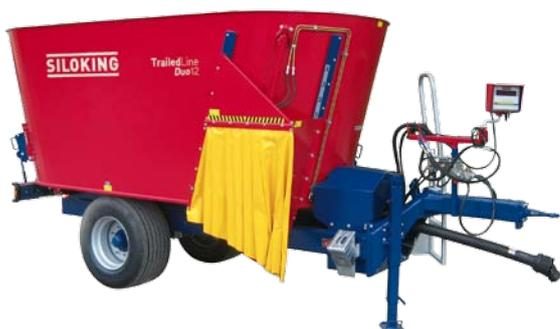
Der SILOKING Standard – Austragsschieber vorn rechts.
