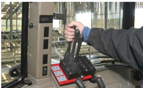
Optional: Steuergerät mit Bowdenzugbedienung.
