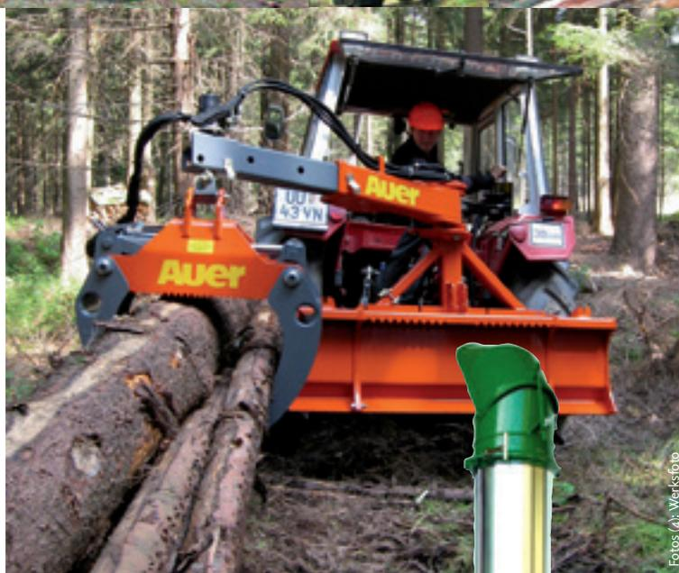
Dreipunktanbau, Seilwinde, Teleskop-, Schwenk- und Hebe-Ladearm mit Reichweiten bis 2 m, zusätzliche Steuergeräte, wenn am Traktor die Öllanschlüsse nicht ausreichen, Schildverbreiterung und vieles mehr – lassen keine Wünsche offen.
