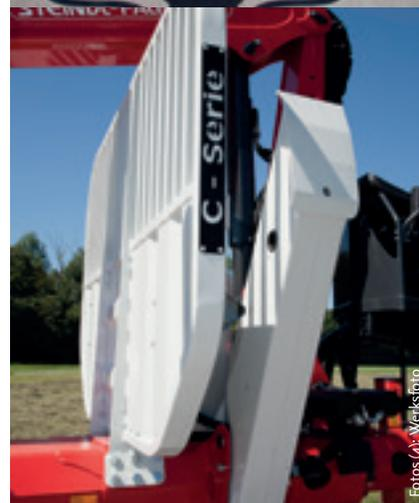
**FRONTGITTER.** Das neue Frontgitter ist größer und verstärkt.
