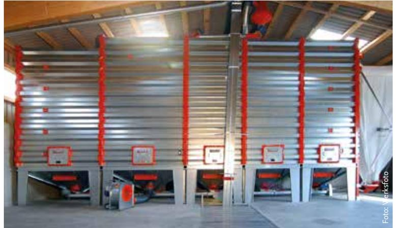
**BAUKASTEN-SYSTEM.** Gruber Getreidesilos sind statisch geprüft und können selber montiert werden.
