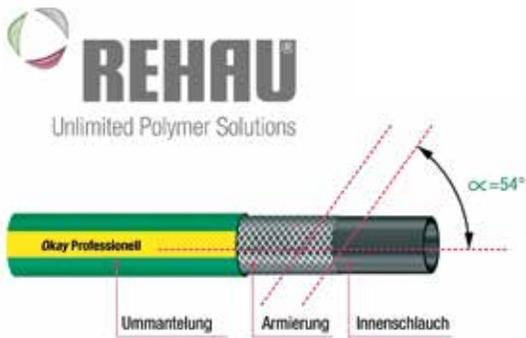
Die Armierungsfäden werden im korrekten Fadenwinkel 54° angebracht, um die Vorteile der Diagonalarmerung zu erreichen.
