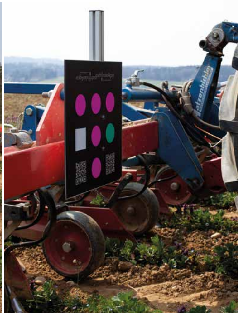
DER BLICK DES BAUERN. Der Blick des Bauern. Die Kamera (o.li.) fokussiert Pflanze, Reihe und Hackgerät, als Referenzierungspunkt dient die Tafel (u.re.). Per App können Parametrierungen durchgeführt und die Pathfinder-Entwickler Strobl, Matzer, Lamprecht und Ulrich (u.li.) zu Hilfe gerufen werden.
